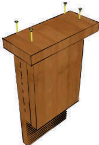
Fixer le toit. Il doit dépasser à l'avant et sur les cotés.
